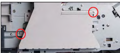
C8 FAN DUCT
